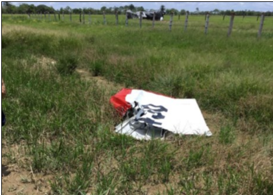
Fotografía No. 04: Parte de plano desprendido después del impacto con el árbol
